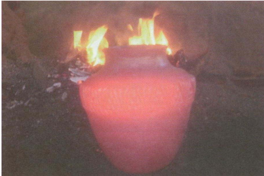
Olla de Cobre al Rojo Vivo ( a unos 900°C
